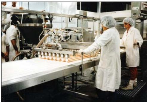
Ведущий разработчик и производитель оборудования для производства тостов, пирожков и сосисок, запеченных в булочки установил насос W032 из нержавеющей стали на установку по производству запеченных сосисок. Для постоянной подачи подготовленного мясного фарша на заданную длину в оболочку из теста со скоростью 5-10 куб. м/час насосы серии W должны иметь систему шнековой подачи, которая обеспечит непрерывную подачу мясного фарша из широкой горловины в рабочий узел насоса.
